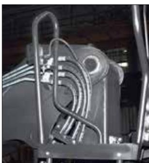
Безопасность соответствует требованиям ГОСТ. Специальное ограждение кресла оператора защищает колени и руки оператора.
